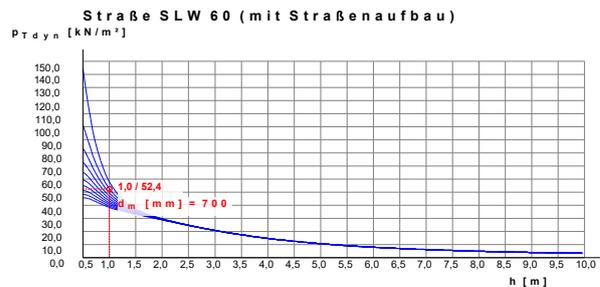
Spannung für Ermüden inkl. Stoßbeiwert:  $p_{Tdyn}$  52,37 kN/m<sup>2</sup>
